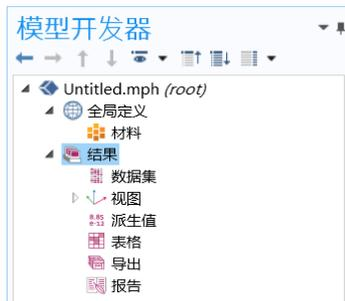
除了这五个默认子节点，您还可以添加更多**绘图组**子节点，用于定义要在**图形**或**绘图**窗口中显示的图形。其中一些节点可根据所执行的仿真类型自动创建，但您也可以右键单击**结果**节点，并从绘图类型列表中进行选择来包含其他图形。
