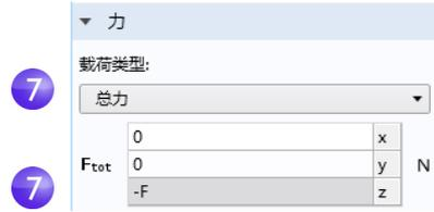
请注意，为简化建模过程，可以使用材料界面边界条件来近似描述螺栓与扳手之间的机械接触。这种内部边界条件是自动定义的，可以保证法向应力与跨材料界面位移的连续性。使用结构力学模块，可以进行包括机械接触在内的更详细的分析。
