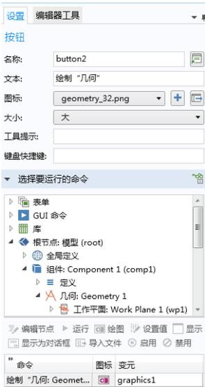
在本例中，**绘制几何**的命令序列包含一个**绘制几何**的命令。输入变元包含有关将几何绘图发送至哪个图形窗口的信息，本例中为图形对象 **graphics1**。
