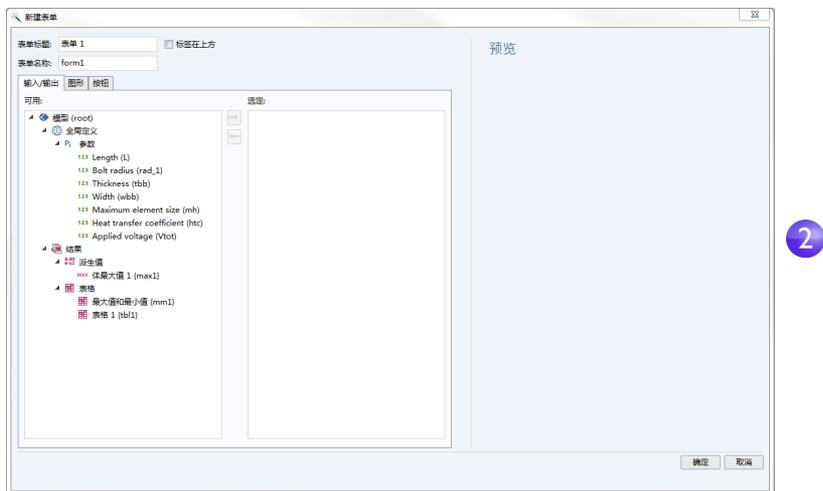
其中包含三个选项卡：**输入 / 输出**、**图形**和**按钮**。在**输入 / 输出**选项卡中，可以双击树中的节点，使其在 App 的用户界面中可用。对于此 App，我们将选择一些参数作为输入框，并选择最高温度作为输出。
