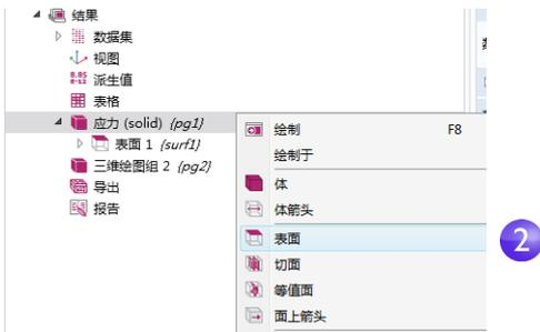
3 在表面的设置窗口中，单击替换表达式按钮
