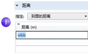
表格支持输入多个值，以创建包含不同材料的夹层结构。在本例中，只需要拉伸一个层。
