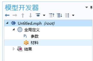
征的值与函数依赖关系。**全局定义**节点本身不含任何设置，但其子节点包含许多设置。**材料**子节点用于存储材料属性，可在模型的**组件**节点中引用。
