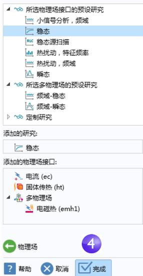
! 物理场接口是针对特定物理领域的用户界面，用于定义方程以及有关网格生成、求解器、可视化和结果的设置。多物理场接口是物理场接口与多物理场耦合的结合体。**焦耳热**多物理场接口由两个物理场接口组成：**电流**和**固体传热**，并与“多物理场”分支中显示的**电磁热**进行多物理场耦合。这种耦合物理场的方法非常灵活，您可以使用每个相关物理场接口的所有功能进行多物理场耦合分析。
