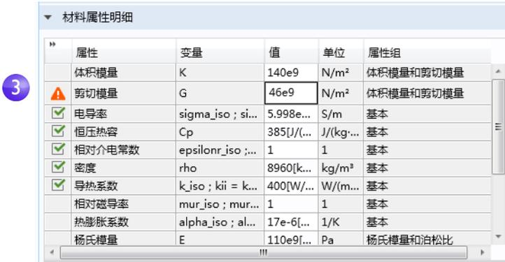
通过添加这些材料属性，您更改了 **Copper** 材料。可以将此信息保存到您自己的材料库，但不能保存到只读的“固体力学”材料库中。
