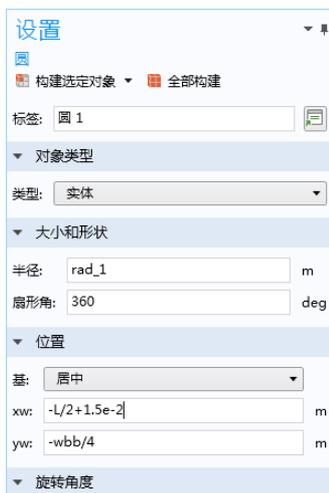
复制刚创建的圆，在母线板中生成第三个螺栓。
