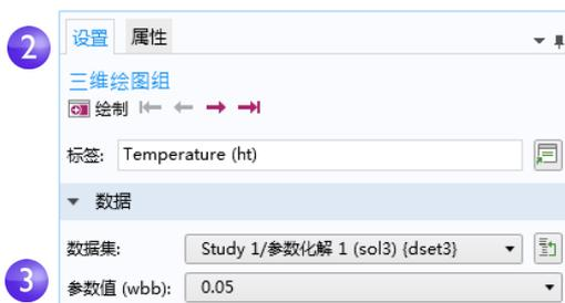
3 在参数值列表中，选择 **0.05**（表示  $wbb=5\text{ cm}$ ）。单击绘制按钮
