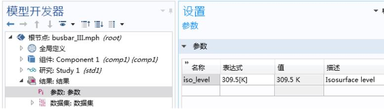
3 对于等温线 (ht) 1 绘图组，在等值面图的设置窗口中，将定义方法更改为水平。在水平表达式栏中键入 `iso_level`。
