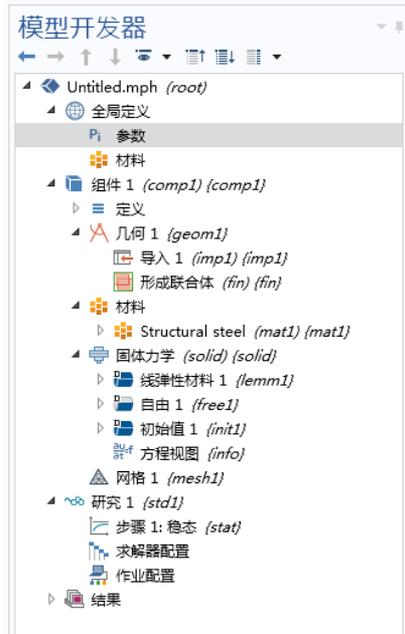
默认的物理场节点不能被移除。您可以添加附加节点来指定与默认节点不同的物理场设置。这些附加节点可以替代默认节点及其他节点的设置，也可以起到一定的帮助作用。有关更多信息，请参见第 113 页的“替代和贡献：独占和贡献节点”。
