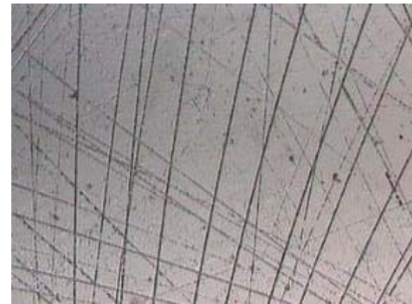
Original : Ra 0.05 \mu\text{m}
