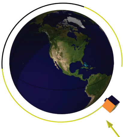
图3 在轨卫星的可视化，显示了相对于太阳和地球的位置和方向，以及对卫星暴露面的辐射。地球图片来源：Visible Earth 和 NASA。
