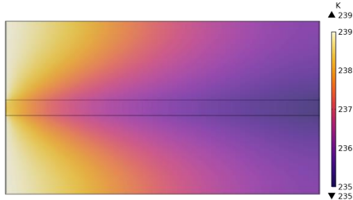
图 13. 多孔介质结构温度分布图
